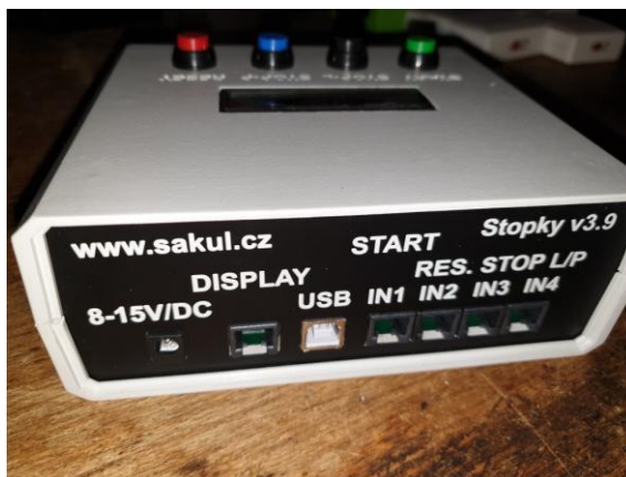
Stopky v3.9 zabudované v univerzální přístrojové krabičce, která byla upravena na CNC.
