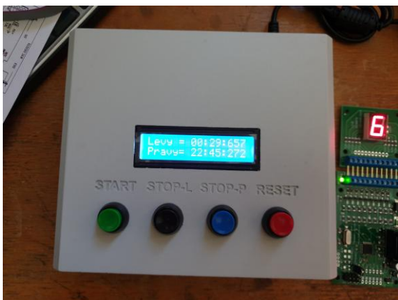
Stopky v3.9 zabudované v univerzální přístrojové krabičce, která byla upravena na CNC.
