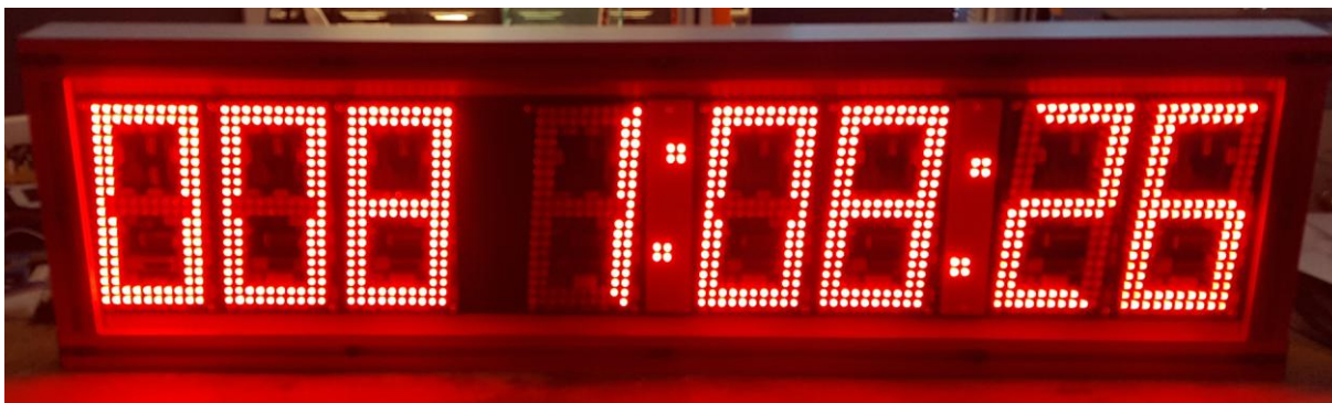
Displej stopek s počítadlem kol pro závodní dráhu.
